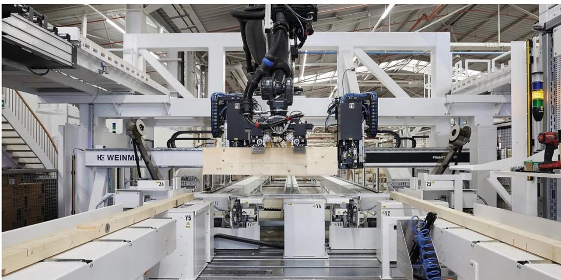
**Abbildung 23:** Automatische Abbund- und Montageanlage in der Produktion [118]
