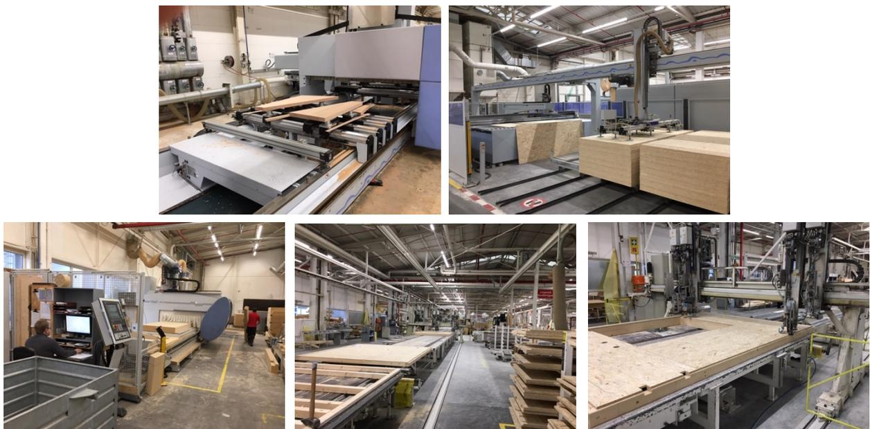
**Abbildung 22:** Produktionsbilder von der Fräs- und Abbundmaschine, der Wandlinie und der automatisierten Nagelmaschine (von oben links beginnend)
