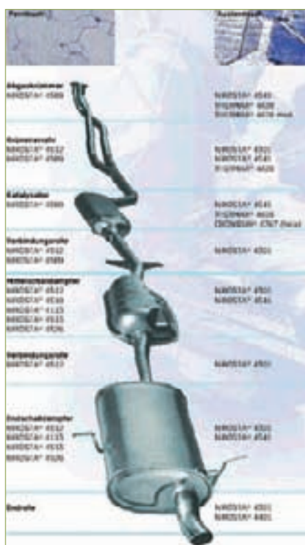
ABB. 2: DER EINSATZ NICHTROSTENDER STÄHLE IN PKW-ABGASANLAGEN [3]
