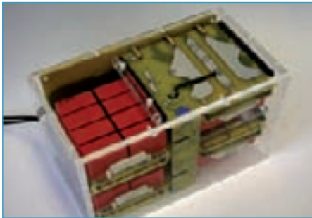
ABB. 9: LEISTUNGSTEIL DES NEUEN ELEKTRONISCHEN HOCHSPANNUNGS-STOSSSTROM-GENERATORS (EHSG)
