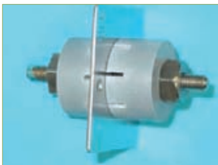
ABB. 7: PROBE MIT SPALTKORROSIONSBLOCKEN
