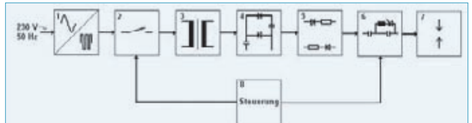
Abb. 8: BLOCKSCHALTBILD DER LADESCHALTUNG
