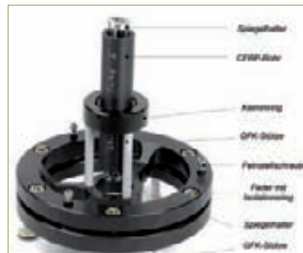
ABB. 11: FOTO DES HALTERS MIT EINGESPANNTEM CFRP-ROHR
