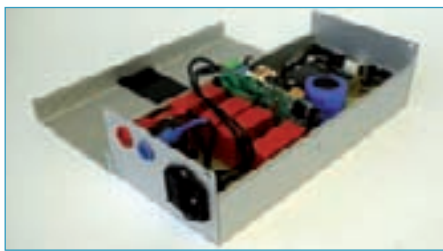
ABB. 10: DIE IM RAHMEN DER DIPLOMARBEIT ENTWICKELTE LADESCHALTUNG IN GEÖFFNETEM ZUSTAND
