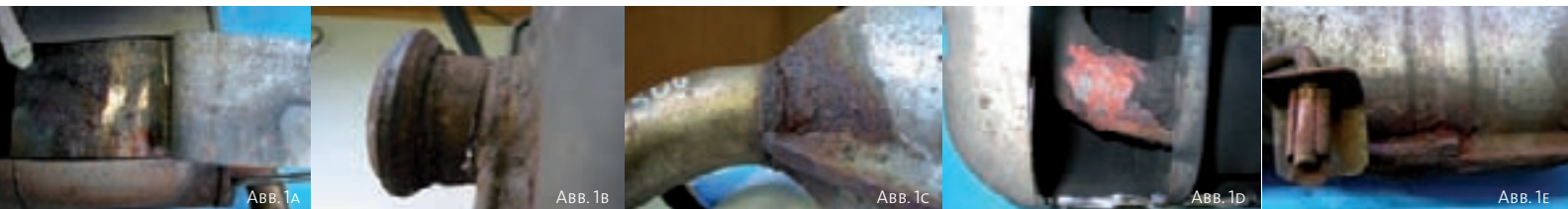
ABB. 1: SCHADENSBLDER VON ENDSCHALLDÄMPFERN
