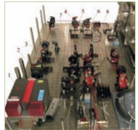
ABB. 4: OPTISCHER AUFBAU ZUR FREQUENZERZEUGUNG (1: LASER; 5 UND 6: AOMs)
