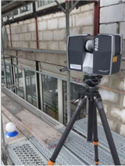
Abbildung 9: Ein 3D Laserscanner bei der Aufnahme eines Bestandsgebäudes
