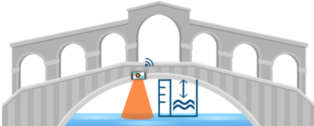
Abbildung 13: Pegelmessung an Brücken (IoT-Shop, 2024)
