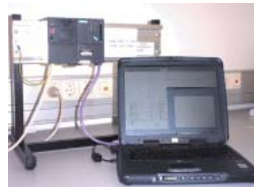
Abb. 3: Hardware-in-the-Loop-Testsystem mit SPS und Simulationsrechner
