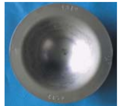
Abb. 3: Ansichtsaufnahme einer tiefgezogenen Probe [Kalotte]
